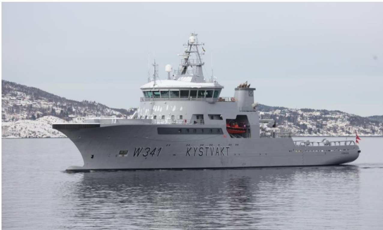
Figur 1: Kystvaktskipet "Bergen" som har LNG som drivstoff til hovedmotor (foto fra www.forsvaret.no ).
